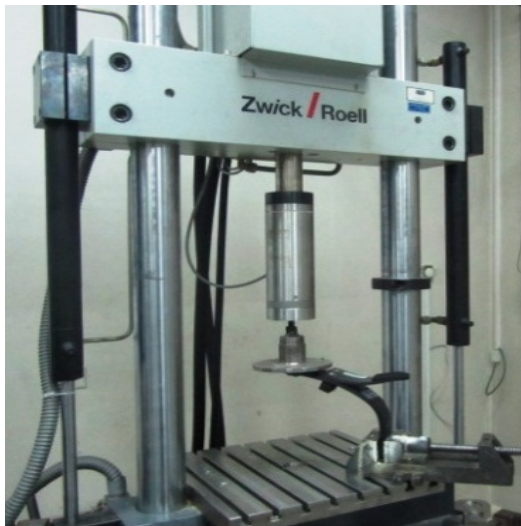
تصویر ۳: نحوه انجام آزمون نیرو - تغییر شکل در بخش جلوی پروتز کربنی
