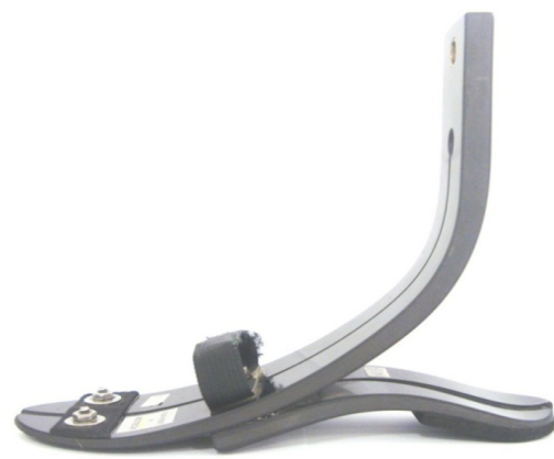
تصویر ۲: پنجه پروتزی فلکس فوت مورد آزمایش
