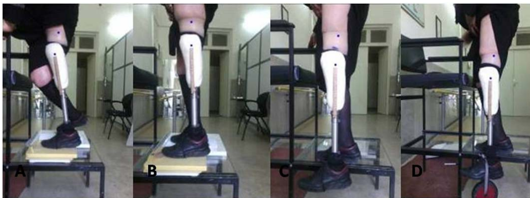
شکل ۱) مراحل چهارگانه آزمون استاتیک. تحمل وزن کامل (A)؛ تحمل وزن نیمه (B)؛ بدون تحمل وزن (C)؛ و اعمال بار ۳۰ نیوتنی (D)
