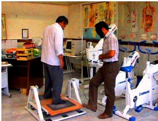
شکل شماره ۱: تخته تعادل و روش اندازه گیری تعادل ایستا
